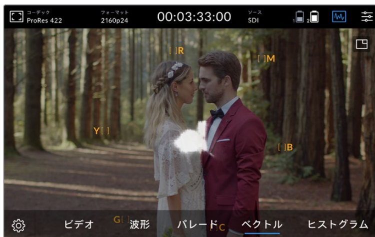
ベクトルスコープはイメージの色相と彩度の全範囲を表示
